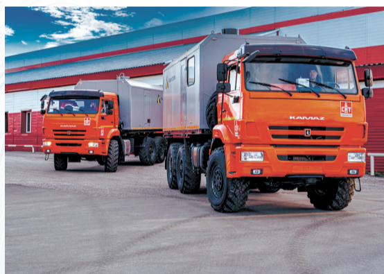
Верхнее оборудование новых ППУА, поступивших в «Усинское ТТУ», — комбинированная топливная система — работает на дизтопливе и СУГ. Это обеспечит снижение затрат на ГСМ.
