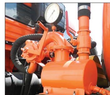
На снимке: детали вакуумной машины, изготовленные с помощью листогибочного станка.
