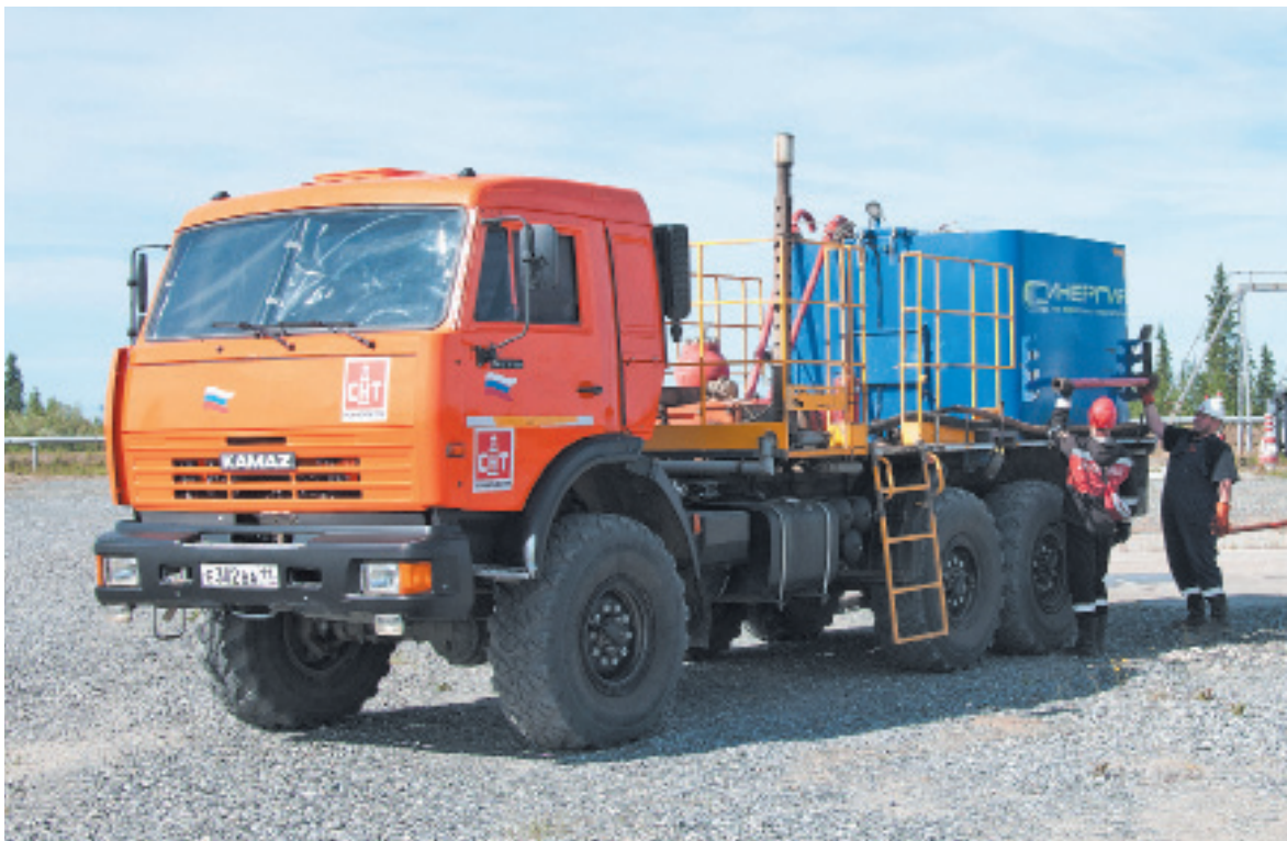
«ЦА-320» ООО «Усинское ТТУ» ведет промывочно-продавочные работы на месторождении ТПП «ЛУКОЙЛ-Усинскнефтегаз».
